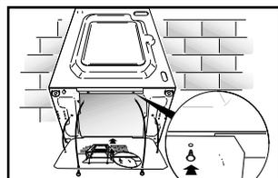
Mettre la machine à niveau en réglant les 4 pieds:
